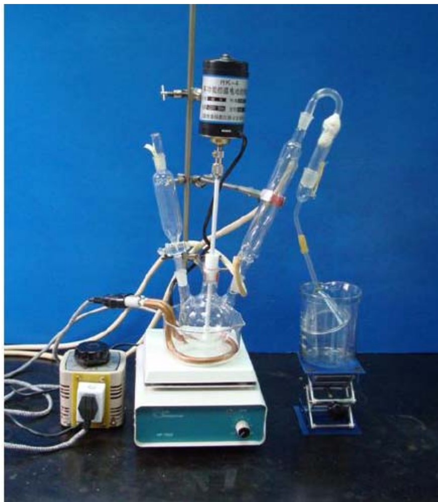
机械搅拌装置
